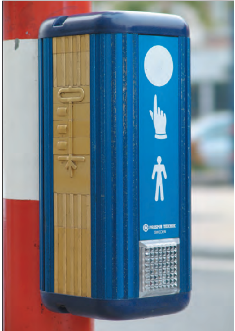
Figure 1: ce système sonore muni d'indications en relief renseigne le piéton aveugle ou malvoyant sur le type de traversée.
